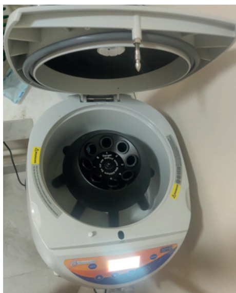
Figura 3: Centrífuga Bianco Lab. Centrífuga digital para 8 tubos homologada para PRP/PRF/L-PRF/A-PRF.
