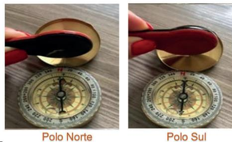
Legenda: na primeira figura o polo norte do imã atrai a ponta da agulha da bússola, já na segunda o polo sul repele a agulha da bússola.
