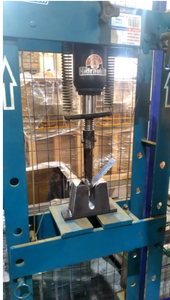
Figura n. 05 – dispositivo de teste do corpo de prova.
